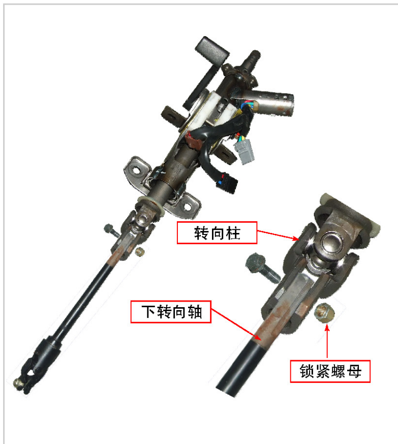
图6-15 下转向轴的拆卸
