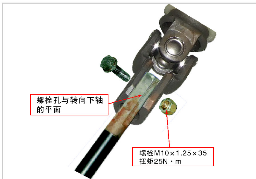
图6-17 安装转向下轴
