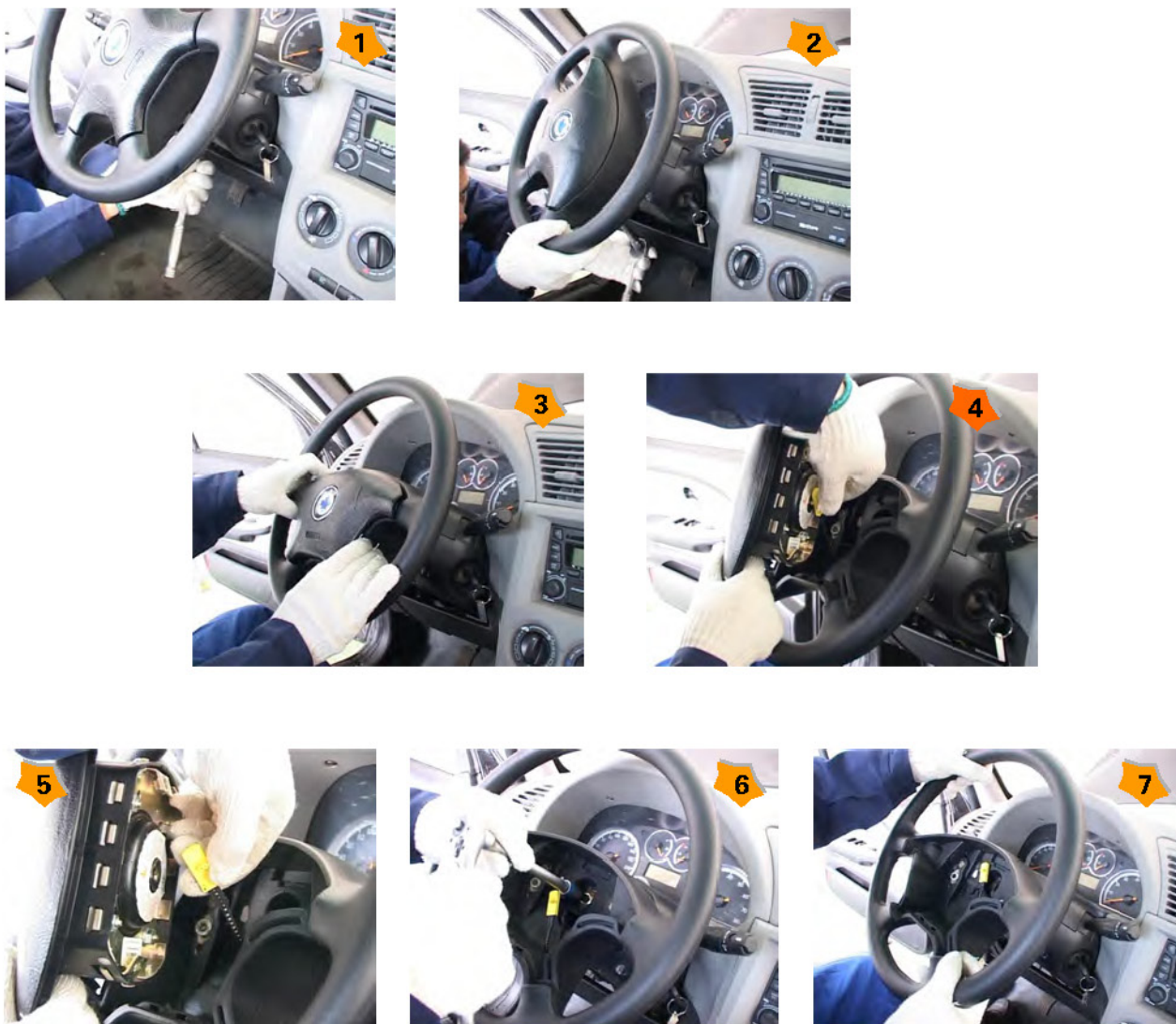
图6-9 方向盘拆卸的过程
