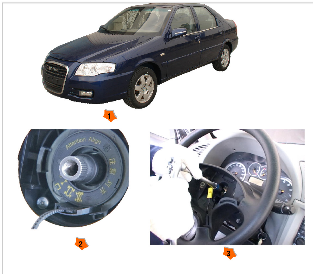
图6-10 方向盘安装的过程
