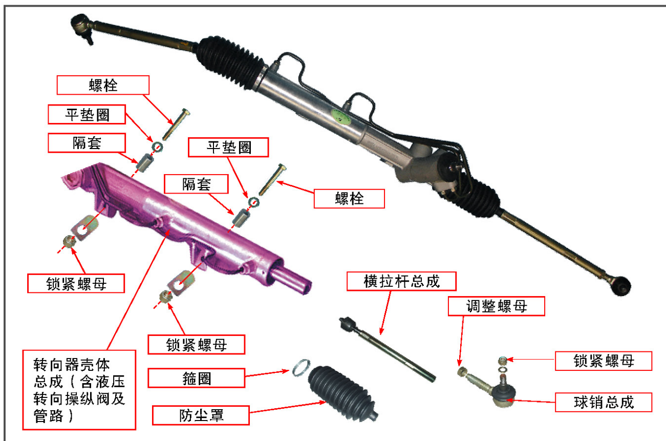
图6-35 转向器总成分解图
