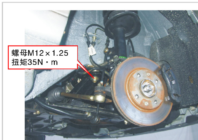
图6-26 拆卸转向拉杆球头
