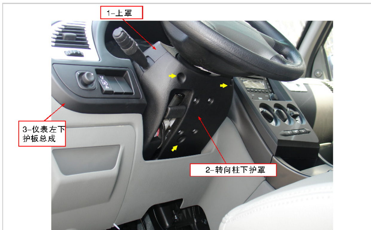
图6-12 转向护罩的拆卸
