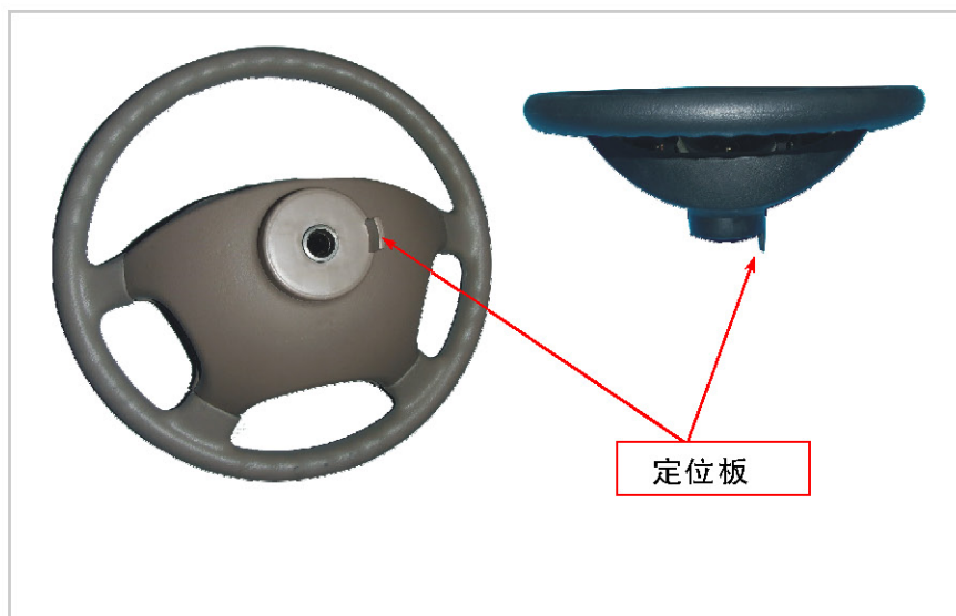
图6-8 方向盘定位凸板与定位槽安装
