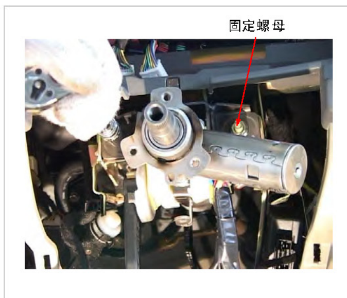
图6-14 拆转向管柱固定螺母
